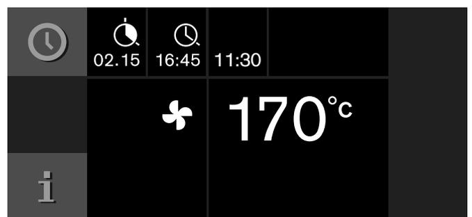
Прибор переходит в состояние ожидания. На дисплее отображается режим работы, температура, время приготовления и время окончания. Прибор запускается в рассчитанное время и выключается по истечении времени приготовления.
